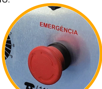
Botão de emergência
