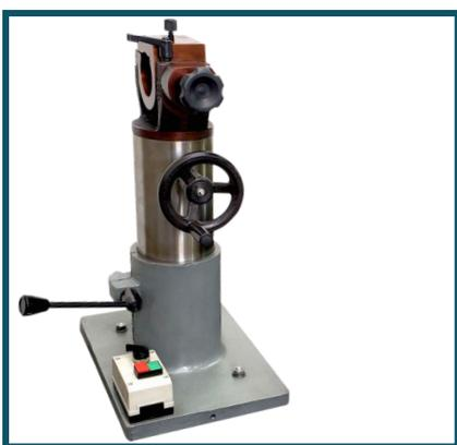
Colunas com sobe e desce controlado por volante
