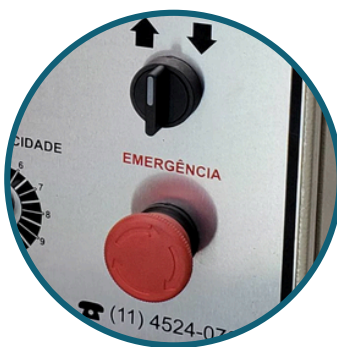
Botão de emergência
