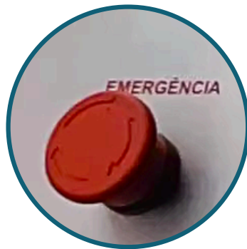
Botão de emergência
