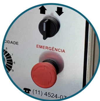
Botão de emergência
