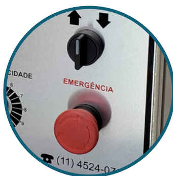
Botão de emergência
