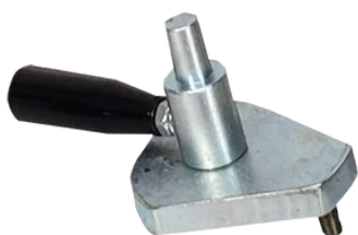
Dispositivo para usinagem do balanceiro
